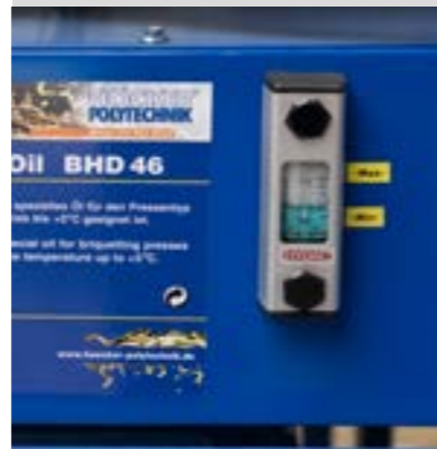
Füllstandanzeige für die Hydraulikölbefüllung.
