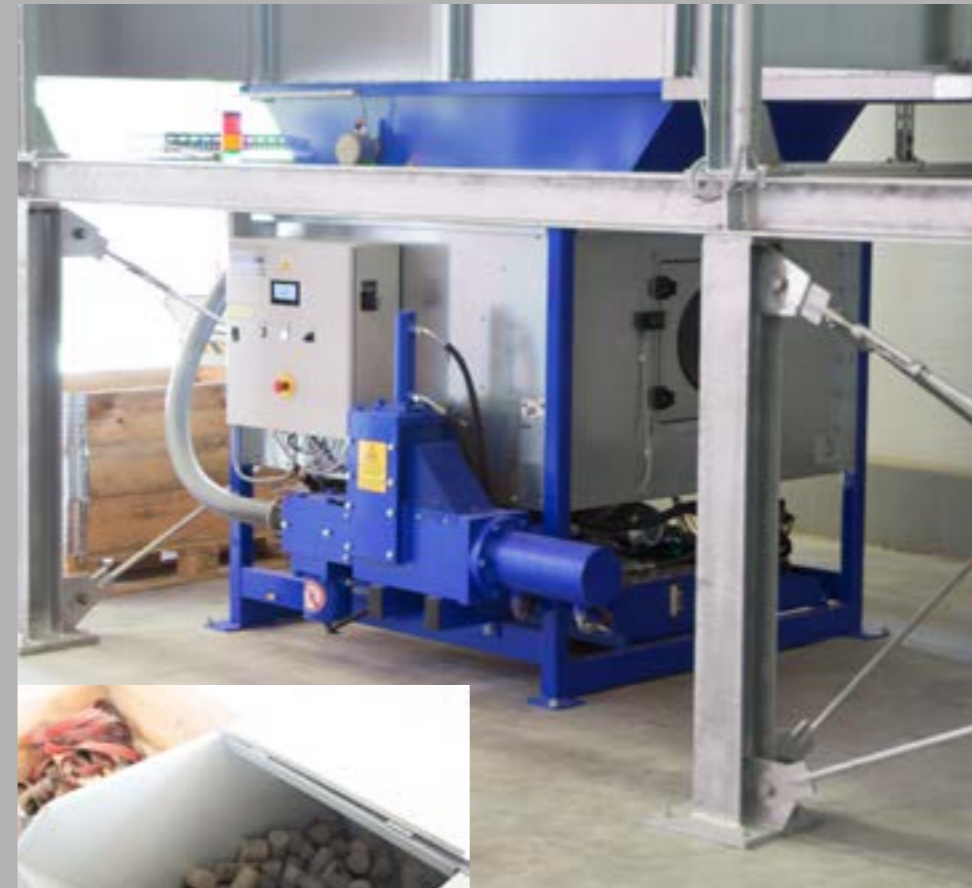
MultiStar Filteranlage mit BrikStar C Brikettierpresse bei einem Hersteller von Verpackungen aus Wellpappe. Sensible Stäube können in Brikettform gefahrlos gelagert werden.
