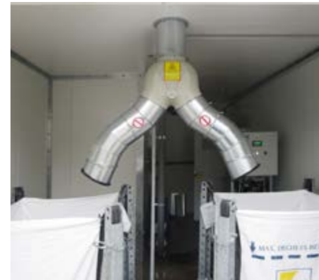
Brikettlagerung in Bigbag Doppelbehälter mit Gestell und Rohrklappweiche. Umschaltung nach voreingestellter Brikettstückzahl möglich.
