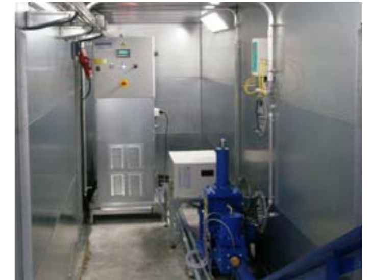
Ein BrikStar V Modell im Kombieinsatz mit einem Schubbodenbehälter und einer MultiStar Filteranlage. Die Anordnung in einer Wetterschutzkabine ermöglicht den komfortablen Zugang. Mit Wasserzangenkühlung für den Dauerbetrieb.
