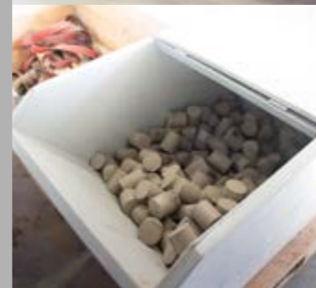
MultiStar Filteranlage mit BrikStar C Brikettierpresse bei einem Hersteller von Verpackungen aus Wellpappe. Sensible Stäube können in Brikettform gefahrlos gelagert werden.
