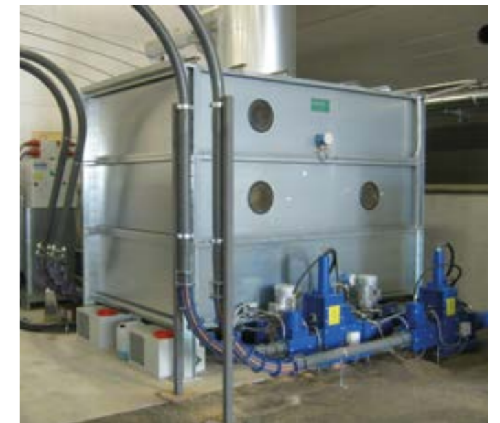
Maximale Brikettleistung mit vier BrikStar V 11 Pressen als Quattrolösung. BrikStar V Quattro Anlage mit 4 x 11 kW Pressen an Schubbodenbeschickungsbehälter (2 x links, 2 x rechts) inklusive Wasserzangenkühlung für den Dauerbetrieb. Behälterbeschickung über Zyklon mit Ringleitung und pneumatischer Transport.
