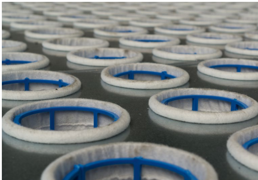
Czyszczenie rękawów filtracyjnych filtra odbywa się przy wykorzystaniu sprężonego powietrza.
