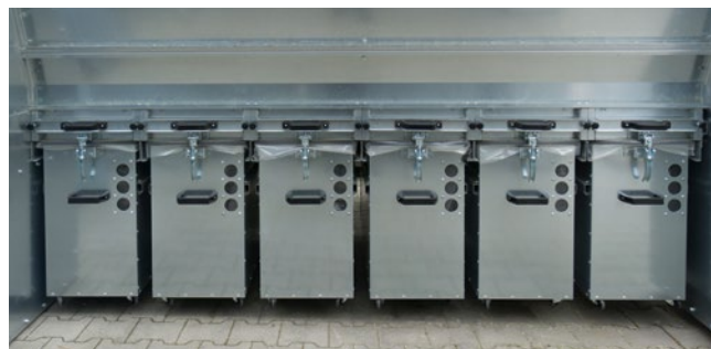
Hybrydowe filtry MultiStar CT wyposażone są w 6 zbiorników o pojemności 1050 litrów, w których zbierane są wytrącone w filtrze odpady.
