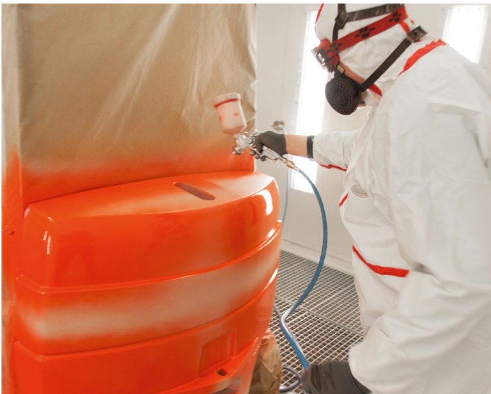
Lakierowanie elementów wózków widłowych.
