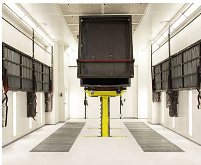
Kontenery prasujące są podnoszone i opuszczane za pomocą hydraulicznych podnośników roboczych. Dwa pomosty robocze przy ściankach kabiny ułatwiają lakiernikom dostęp do wszystkich powierzchni lakierowanych kontenerów prasujących.
