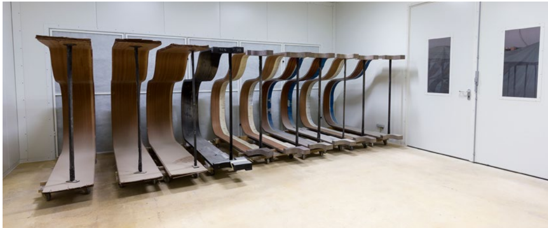
Im Trockenraum härtet der Lack bis zu 20 Tage aus. Danach wird er geschliffen, geschwabbelt und auf Hochglanz poliert.
