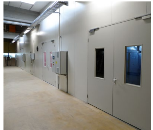
Zum 148 m 2 großen Lackierzentrum gehören die Lackierkabine, der Trockenraum, der Aggregaterraum und der Applikationsraum Quelle: Hoecker Polytechnik
