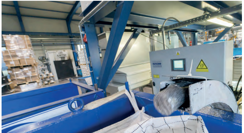
Bis zu einer Tonne Aluminium- und Magnesiumspäne werden bei BBS Motorsport zu Briketts verpresst.
