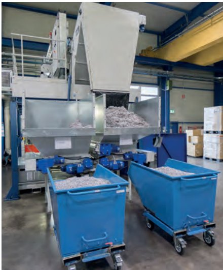
Manuelle Befüllung der iSwarf Brikettiermaschine, Aluminium (l.), Magnesium (r.)
