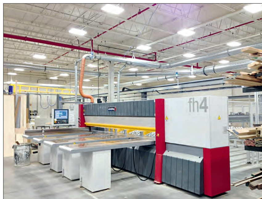
Aktuell sind 30 Maschinen über automatische Absperrschieber angekoppelt
