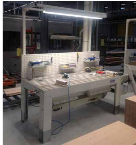
Expert Z20 Schleifstaubabsaugtisch mit Beleuchtungsoption im Praxiseinsatz
