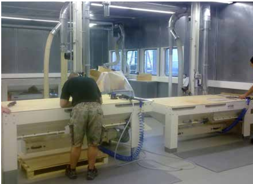
Zwei Expert Z 20 Schleifstaubabsaugtische in der Lackiervorbereitung
