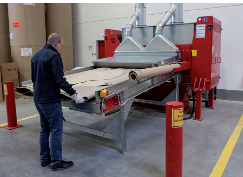
Der Shredder verarbeitet Bogenware und Hülsen
