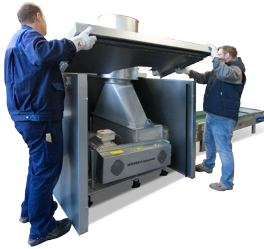
Opcjonalna obudowa dźwiękochłonna do Shreddera PHSS-K/B obniża emisję hałasu w obszarze roboczym.
