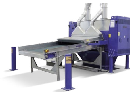
Shredder PHS/PHSH Rozdrabnia arkusze i tuleje tekturowe (PHSH)
