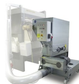
Shredder PHSS-K/G Rozdrabniacz do chwytów i ramek z tyłu sztancy.
