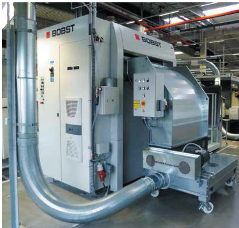
Stanzgitter-Greifer- randschredder vom Typ PHSS K/G.
